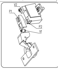
Канавка винта V1 должна войти в паз P2 планки, паз петли P1 должен войти под головку винта V2
